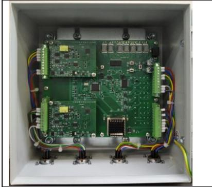
Сигнализатор раскрутки турбины предназначен для контроля частоты вращения вала силовой турбины ГПА и сигнализации при достижении (превышении) заданных частот вращения. Устройство имеет возможность применения и в других вариантах использования в качестве сигнализатора заданной частоты сигнала или частоты вращения вала. Устройство может использоваться автономно, в составе систем аварийной защиты и систем автоматического управления ГПА
