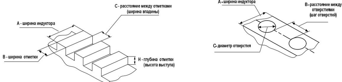
Рис.3. Геометрические параметры индуктора
